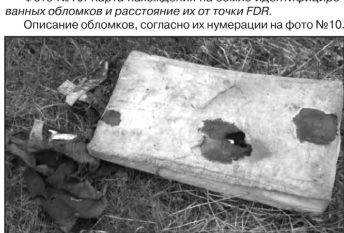
Фото №12. Обломки №2. Обгорелые фрагменты транзитных воздуховодов. Обломки №1 и №2 найдены Николаем Варсеговым во время командировки КП 16 апреля 2018 года.
